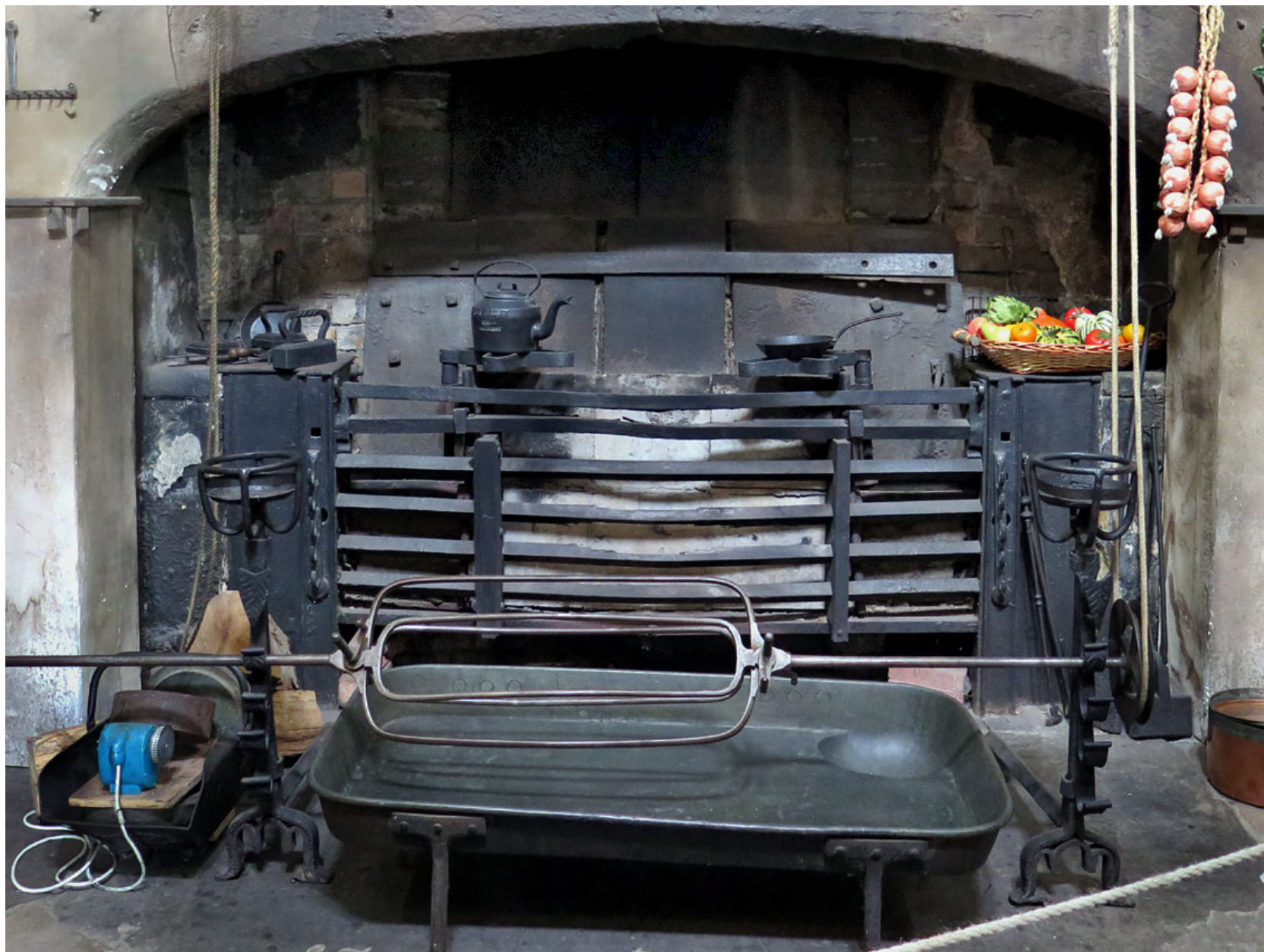
I kökets skorsten drev värmen från elden en fläkt, som i sin tur fick grillspettet att rotera.
